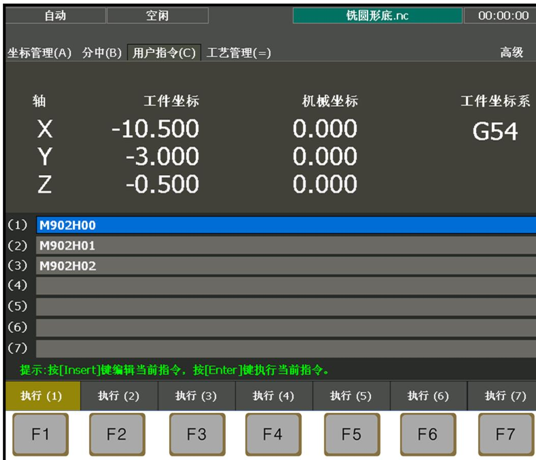
2. 方向键选择编辑行，按插入 ( Insert ) 键，在弹出的对话框输入编程指令。
