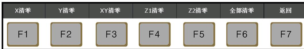
3. 按下对应操作键（F1、F2……），执行单轴清零（如“X轴清零”、“Y轴清零”等）或“全部清零”。清零后，系统自动将当前点的机械坐标值设置到各轴工件偏置中。
