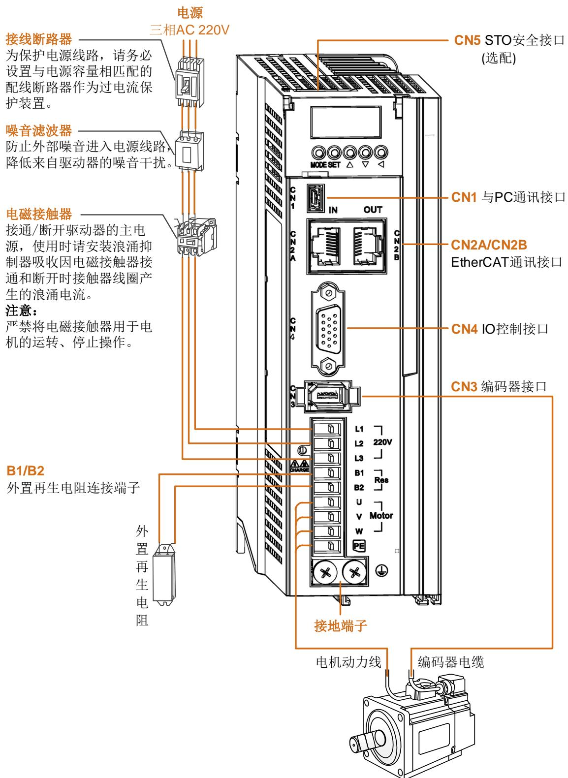
图 1-5 B1 伺服驱动器与外围设备连接图
