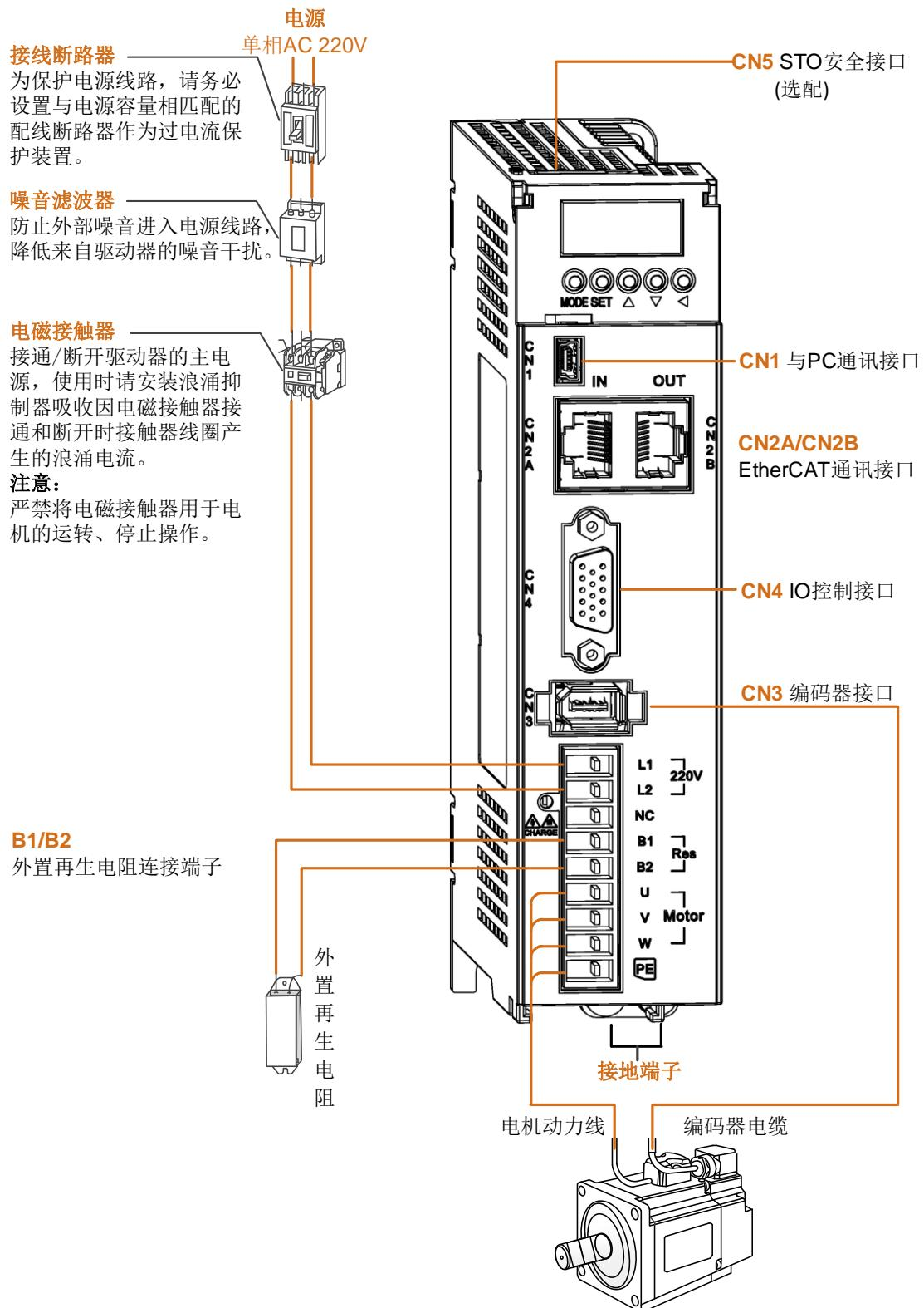
图 1-4 B1 伺服驱动器与外围设备连接图
