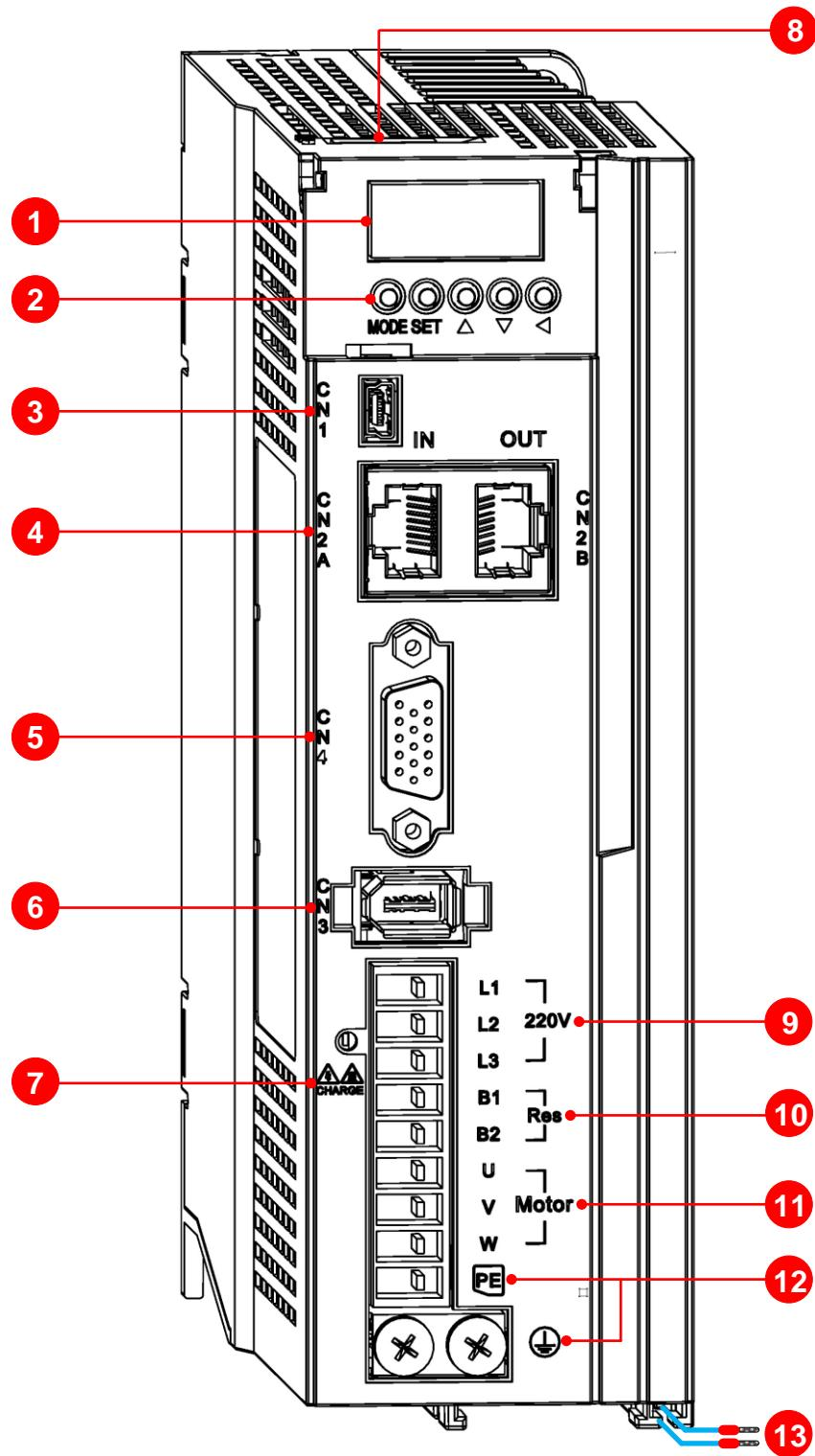
图 1-2 B1 伺服驱动器组成（总线型）
