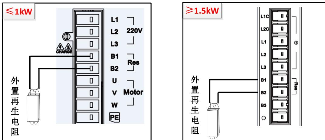
图 3-1 外置再生制动电阻连接示意图
