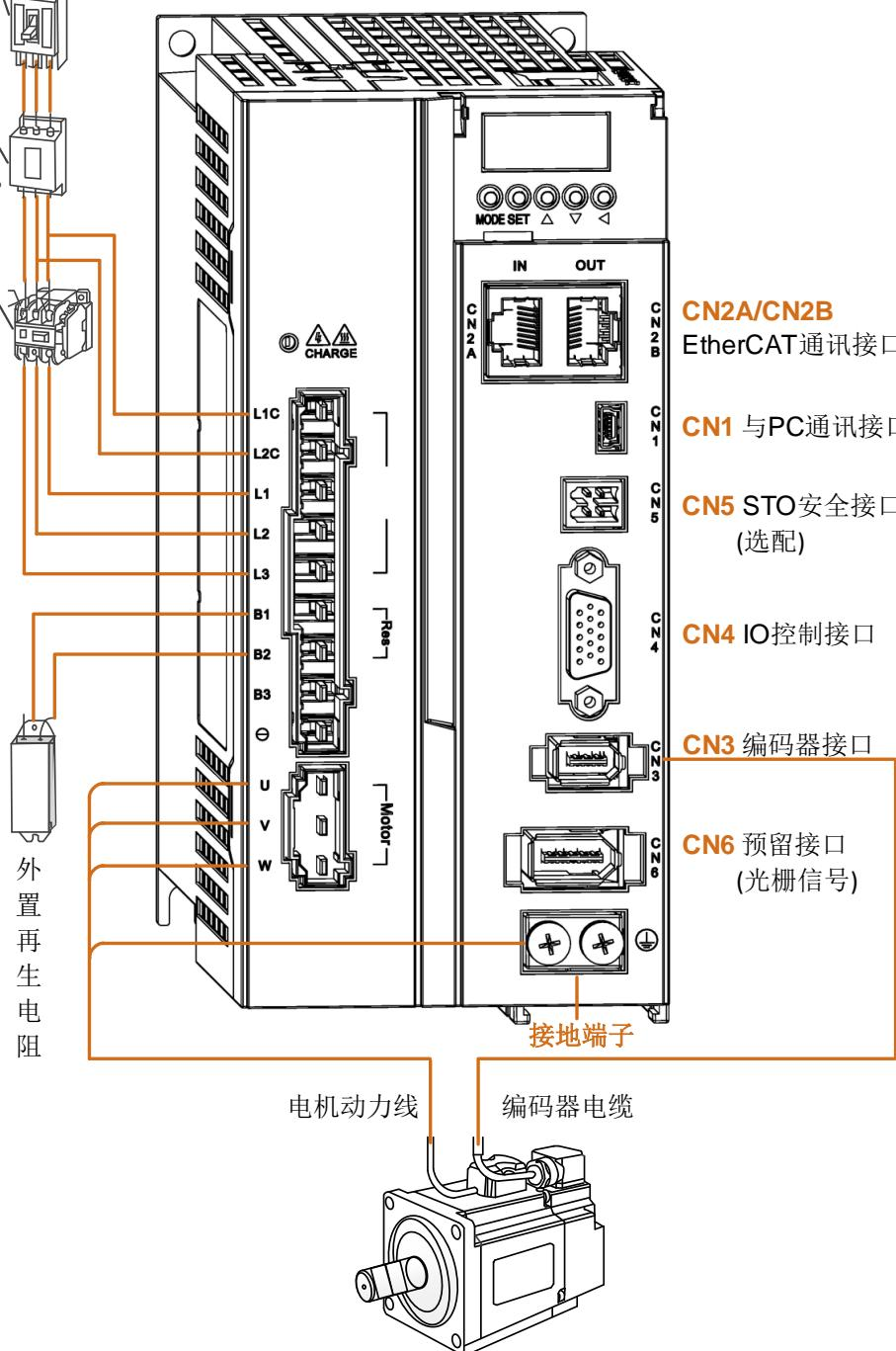
图 1-6 B1 伺服驱动器与外围设备连接图
