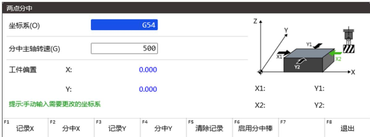
3. 选中 **坐标系** 输入框并按 **Enter**，在弹出的输入框中输入目标工件坐标系。
