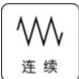
**连续**：进入 **手动连续** 模式，长按单个或多个轴方向按钮，轴以连续低速移动直至松开。
