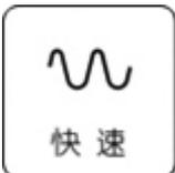
**快速**：进入手动快速移动状态。按下该键后长按轴方向键，轴以手动连续高速移动直至松开。
