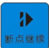
：加工中出现断电、紧停等异常情况时，将机床快速移动到断点处，并从断点行继续执行程序。
