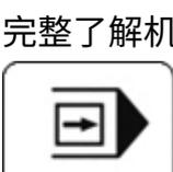
**单段执行**：进入 **单段执行** 模式，执行单段加工，一行一行的执行程序指令，检验机床动作的正确性。
