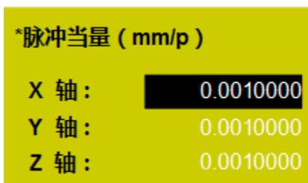
4. 使用手持盒数字按键，修改脉冲当量值并按
