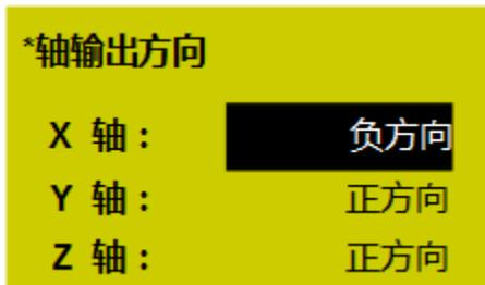
4. 根据右手法则坐标系，判定 X 轴的正方向。
