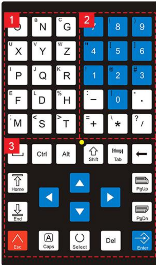
1.字符按键区 2.方向、数字按键区 3.系统操作按键区
