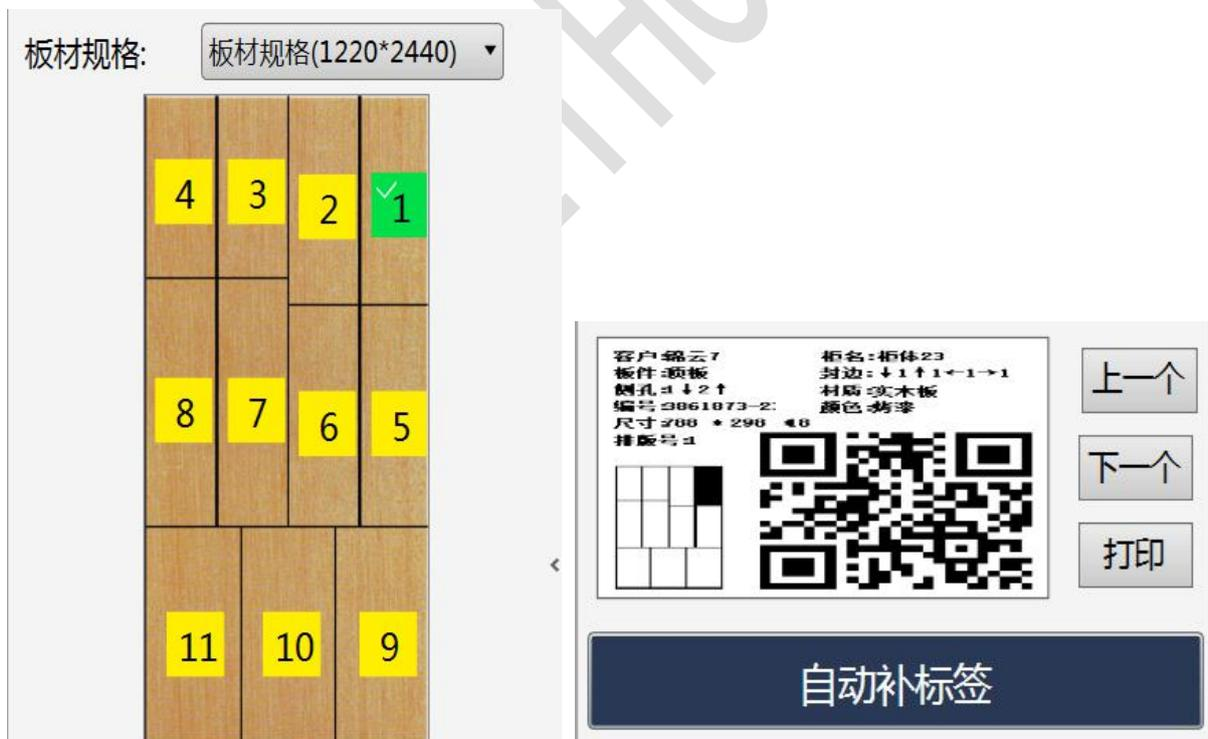
该模式加工列表中板材的尺寸规格，标签数量和位置，开料加工轨迹。
