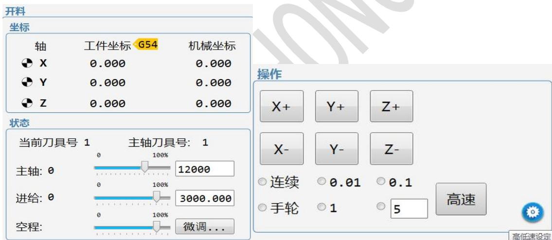
通过界面按钮 X+、X-、Y+、Y-、Z+、Z-，控制开料机 XYZ 的机械坐标，界面可选择连续、手轮或步进模式。
