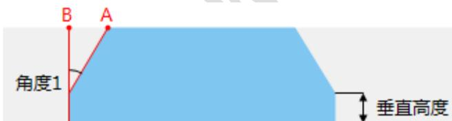
工序中包含两次切割，即一次直切切割，一次 V 型切割组合成 Y 型切割。
