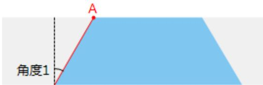
激光光速方向与板材水平面始终保持一个角度切割。支持变坡切割，变坡角度范围为 $-45^{\circ}$ 至 $45^{\circ}$ 。
