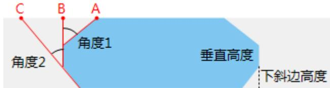
工序中包含三次切割，即一次 V 坡（坡角 a）、一次直切、一次 V 坡（坡角 b）组合成 K 型切割。
