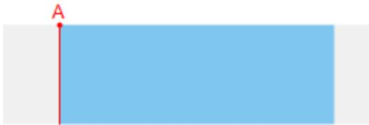
激光光速方向垂直与板材表面切割，无需切割坡口，与常规平面切割相同。
