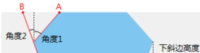
工序中包含两次切割，即一次 V 坡（坡角 a）与一次 V 坡（坡角 b）组合成 X 型切割。
